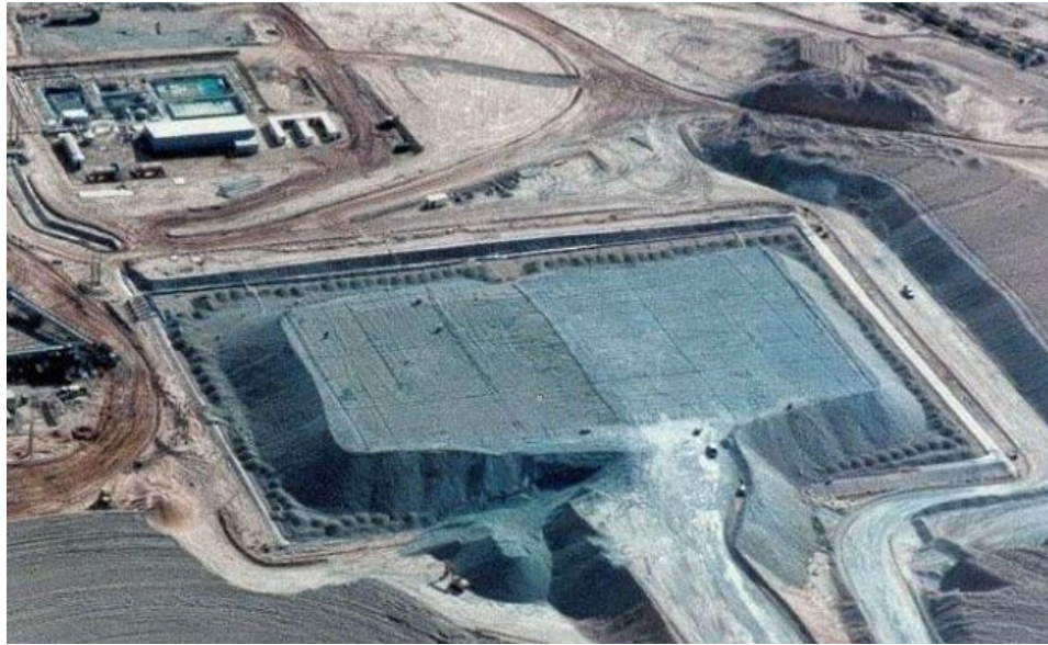
Figura 5. Método convencional para la extracción de metales con valor "lixiviación en pilas"
